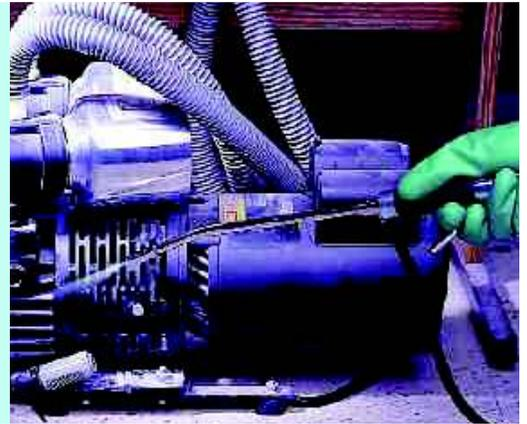
**LIMPIA Y DESENGRASA “IN SITU” MOTORES ELÉCTRICOS EN FUNCIONAMIENTO, REDUCIENDO EL PELIGRO DE INCENDIO**
