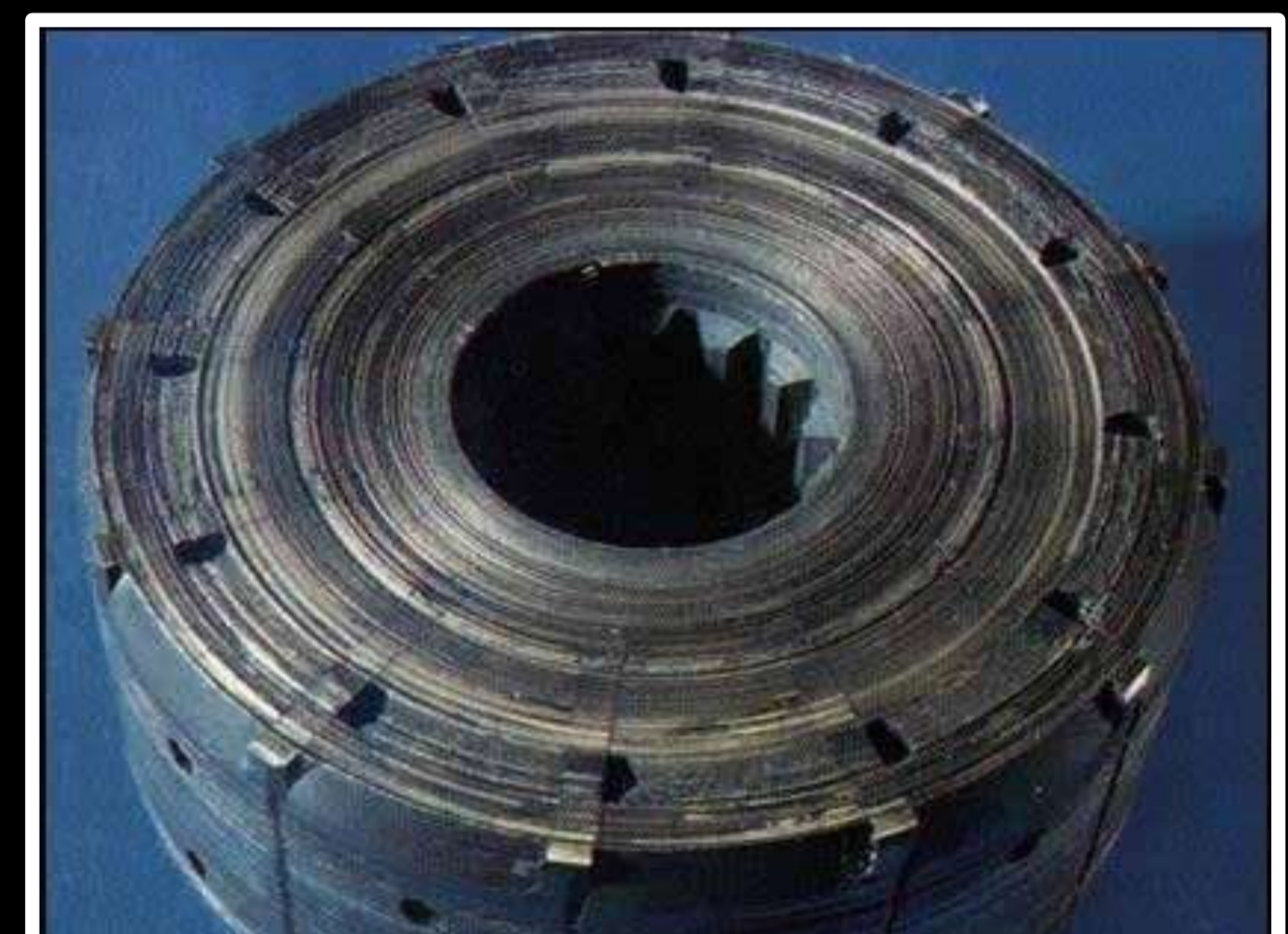
Rotor de bomba de paletas desgastado, si las ranuras de paletas se desgastan más de 2 micrones, no se pueden reconstruir.
