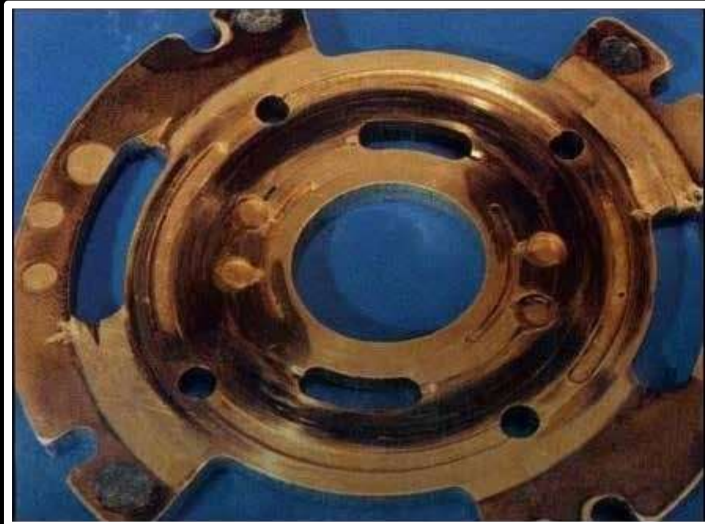
Superficie oxidada de una placa de la válvula de la bomba hidráulica
