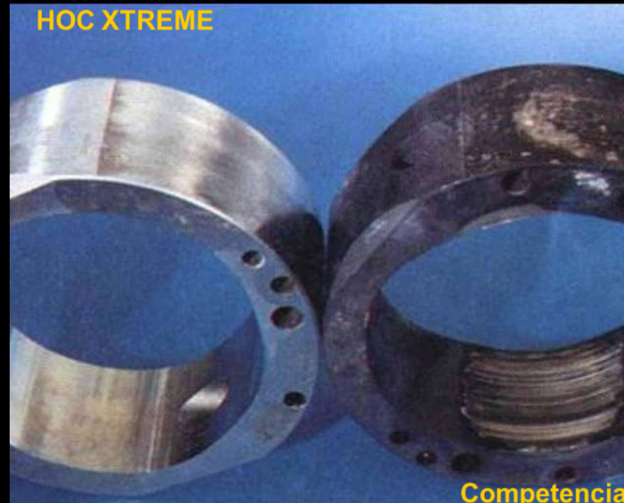
2000 horas bomba de paleta anillos de leva
