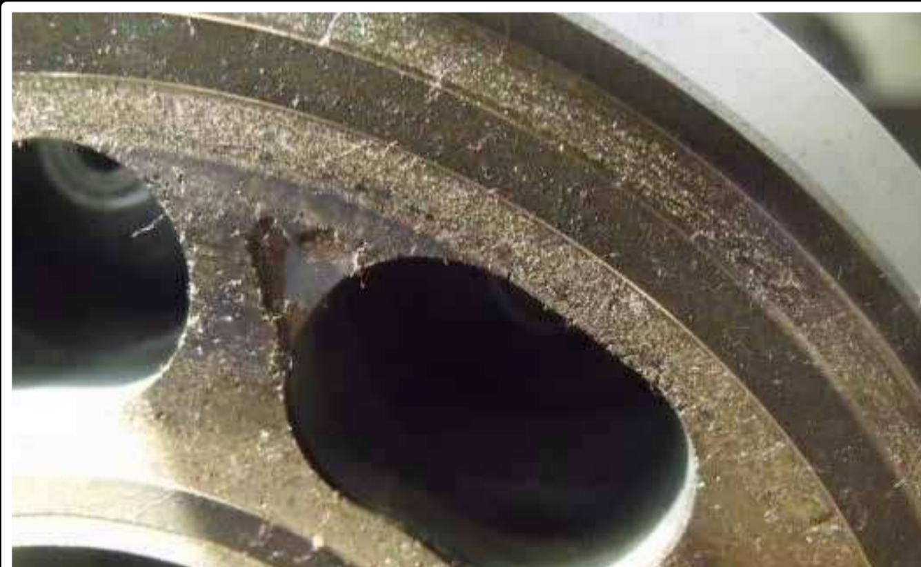
El daño de la cavitación en el plato oscilante de la bomba del pistón conduce al fallo de la bomba
