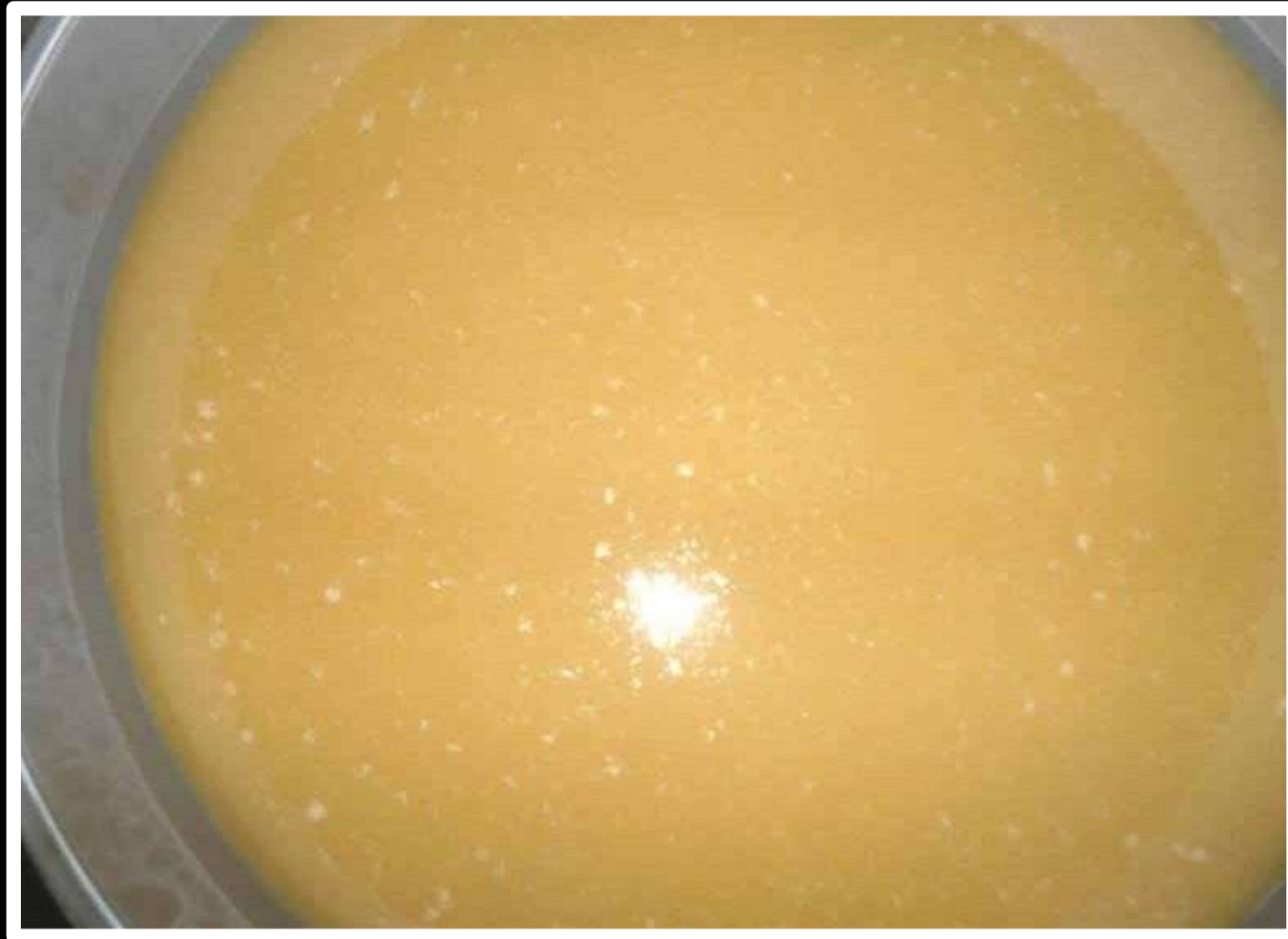
Aceite emulsificado de un depósito hidráulico
