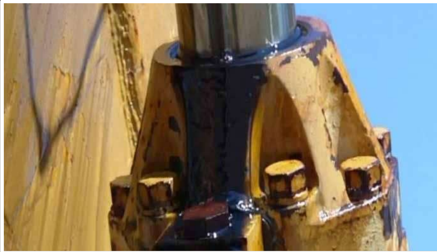
Cilindro con fugas
